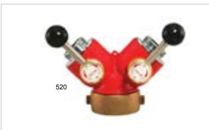
Siamesa con entrada hembra de 2 1/2" y dos salidas macho de 1 1/2" cada una.
