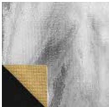
GORE® RT7100 barrera de humedad - Tipo 3D, 4,6 OSY. Compuesto por una membrana GORE™ y un sustrato no tejido Nomex® punzonado de 3,0 OSY.
