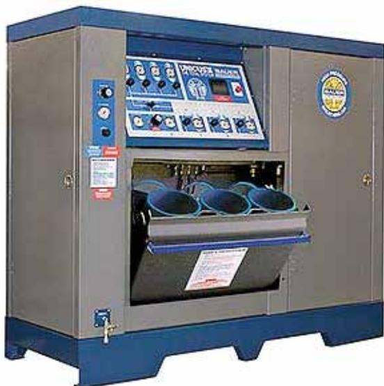
Es el sistema completo por excelencia para el llenado de cilindros SCUBA o SCBA en alta o baja presión. Su diseño de sistema completamente integrado incluye un compresor de aire de alta presión BAUER, sistema de purificación de aire respirable BAUER, bancos de almacenamiento de aire, panel de llenado en cascada y compartimento de llenado a prueba de ruptura de cilindros, todo en una estación de recarga ergonómica, segura y fácil de usar.
