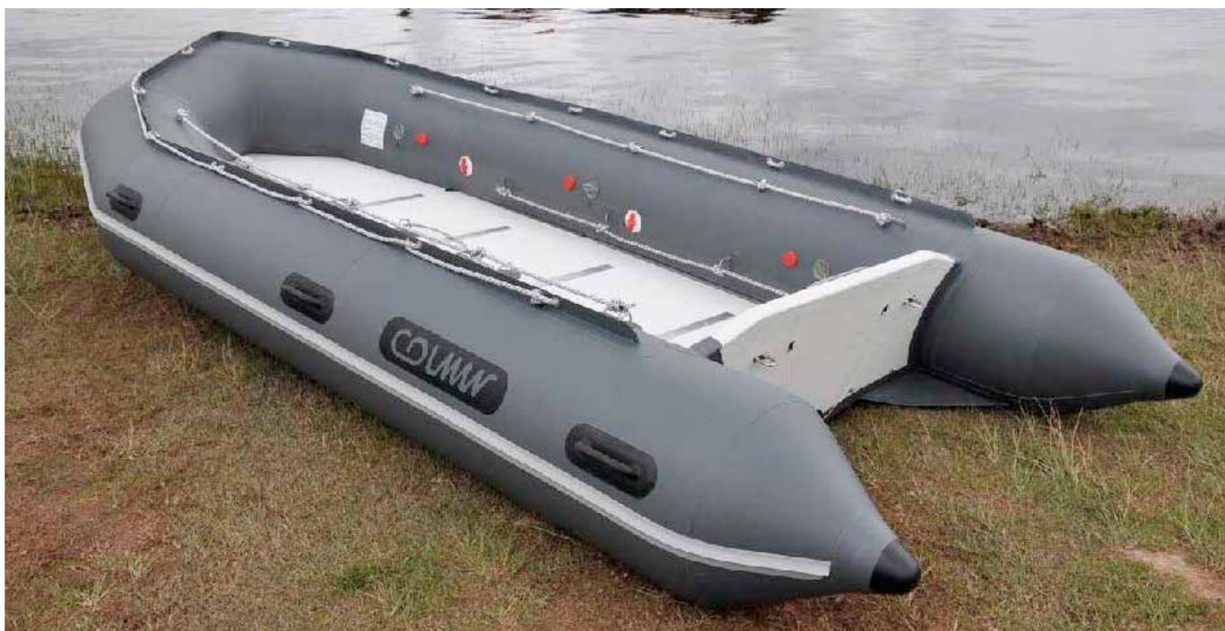
El Bote inflable es de fácil armado, se desenrolla e infla sin necesidad de instalar el piso que ya viene incorporado al casco, anclado en proa a la tabla fija y en popa al espejo.
