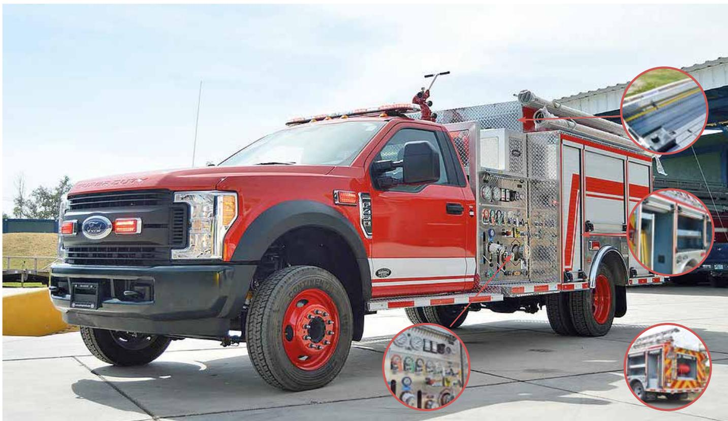
El vehículo de ataque rápido es una de las autobombas de ataque más compactas y rápidas en la industria. Este vehículo cuenta con una carrocería totalmente soldada de aluminio extruido y el módulo de la bomba con plomería en acero inoxidable resistente para muchos años de uso sin problemas.
