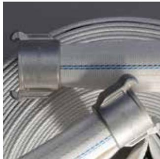
Manguera forestal totalmente sintética. Esta manguera "Ilorona" auto protectora de peso ligero y resistente y flexible ideal para los bomberos y brigadas forestales. Fabricada en fibras de poliéster de alta tenacidad, tubo interior en poliuretano fundido a alta temperatura logrando que sea inseparable de la fibra dando una superficie lisa y logrando bajas pérdidas de presión por fricción.
