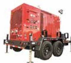
Las bombas montadas en remolque (tráiler) de Hale proporcionan un paquete de supresión de incendios totalmente móvil y autosostenible.
