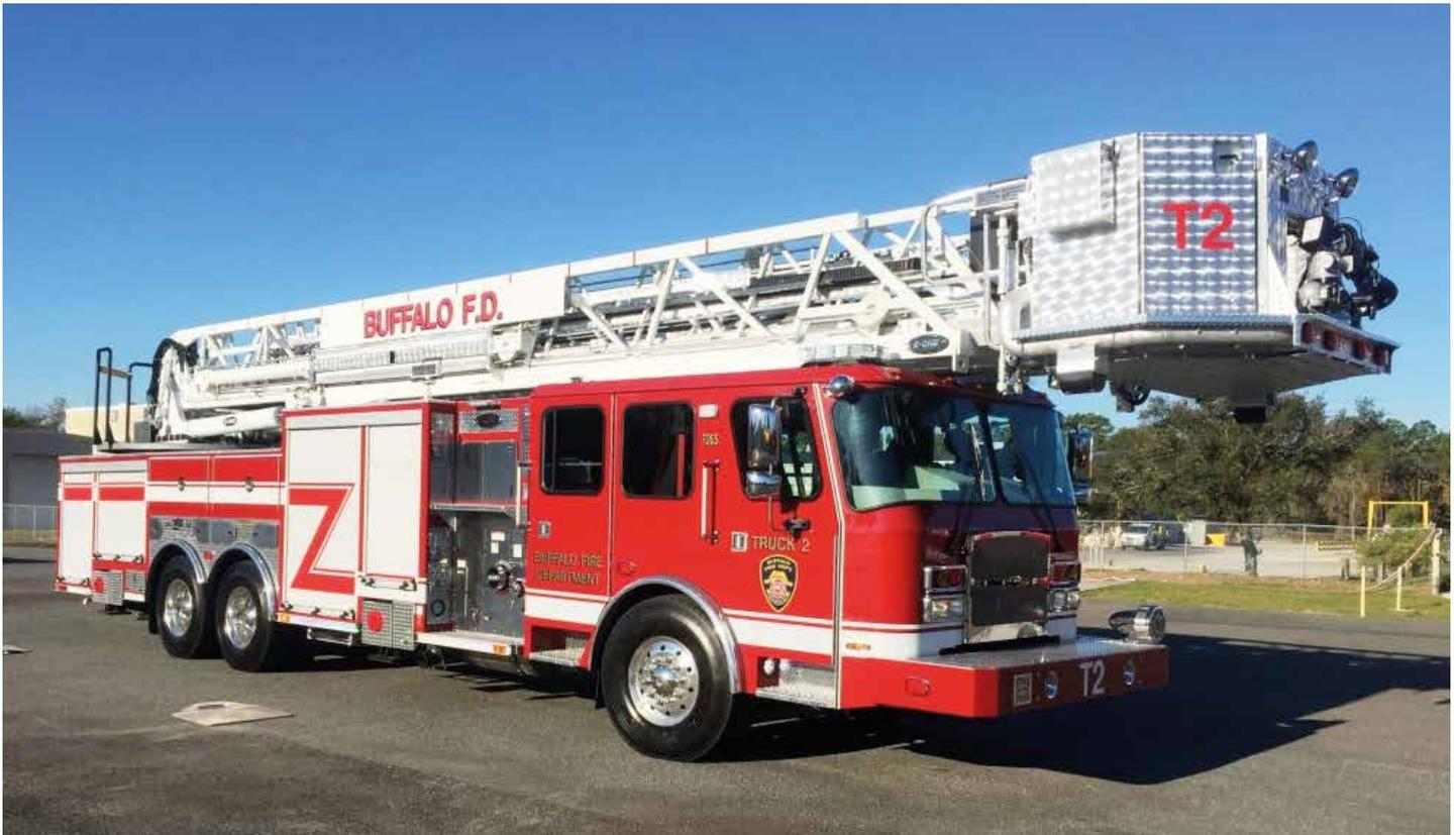
Máquinas escalera y/o Plataforma con una corta distancia entre ejes, permiten un radio de giro reducido para facilitar las maniobras en las vías estrechas o entre el tráfico.
