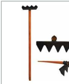
Consta de 4 dientes de corte triangular en forma de acero para herramientas, especialmente endurecido y afilado. Los dientes están clavados firmemente al elemento estructural ángulo de hierro duro. Con mango de 1,48 M de largo de fresno americano. Tamaño de la cabeza: 31cm de ancho x 8,5 cm de alto. Peso 1.77kg
