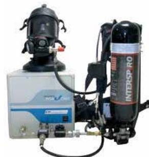
Según la norma NFPA 1852 Norma sobre Selección, cuidado y mantenimiento de equipos de respiración autónoma de circuito abierto (SCBA). Todo SCBA debe ser calibrado antes de ser puesto en servicio y luego por lo menos una vez al año.
