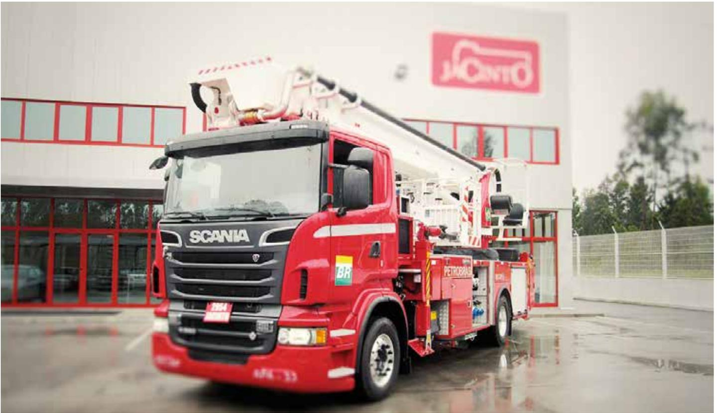
Las máquinas escalera son vehículos mixtos de rescate y extinción con plataformas de rescate en altura y cuentan con un sistema totalmente automático de operaciones, alta velocidad de maniobra y gran fiabilidad. Las escaleras alcanzan hasta 50 m de altura.
