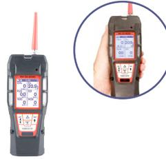
Este poderoso instrumento de mano es capaz de controlar simultáneamente hasta 6 gases. Además de los 4 gases de espacios confinados estándar que incluyen: Combustibles, O<sub>2</sub>, CO, H<sub>2</sub>S. El GX-6000 tiene 2 canales adicionales inteligentes que aceptan PID, infrarrojos o sensores súper tóxicos (EC).
