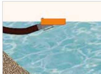
**SUCCION PROFUNDA:** el colador aspira desde unos cuantos centímetros por debajo de la superficie, donde el agua está más limpia. Observe cómo el peso de la manguera inclina la posición del filtro mientras el flotador permanece nivelado. Foto derecha
