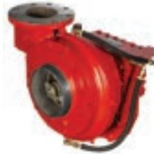
La bomba RSD de Hale es la versión PTO de la popular DSD. Ideal para aplicaciones ARFF y de montaje trasero. Con la capacidad de producir hasta 2000 GPM a partir de hidrante con suficiente potencia, la RSD aporta un alto rendimiento al mercado de montaje trasero. Su diseño compacto y las opciones de caja de cambios y voluta permiten una máxima flexibilidad en el diseño de camiones.
