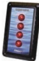
Las pantallas Intelli-Tank™ cuentan con un ángulo de visión amplio. Está diseñado para mostrar el volumen de un líquido con una precisión de un octavo del nivel de un tanque a través de LED ultra brillantes que se pueden ver en un ángulo de 180 grados. La unidad configurada como maestra utiliza un transductor de presión de 0 a 5 PSI para obtener información sobre el nivel del tanque y luego transmite esa información a través de las líneas de comunicación.
