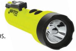
Utiliza un LED de 240 lúmenes que funciona junto con un reflector parabólico profundo de alta eficiencia para crear un haz de linterna utilizable de 178 metros. En la carcasa está integrado un reflector desenfocado de 175 lúmenes que es perfecto para iluminación de primeros planos.
