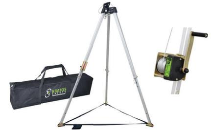
Este trípode cuenta con 2 puntos de fijación en la cabeza Cabeza en aluminio fundido y patas en aluminio; Calzado de soporte de acero provisto de suela de goma para aumentar la fricción. Capacidad de carga max: 500 kg - Altura Maxima: 2.5 mts - Peso: 13 kilos. Incluye: Winche de 20 metros y maleta
