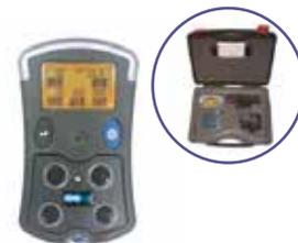
La PS500 se puede adaptar para detectar hasta cinco gases con sus sensores tóxicos y catalíticos, detectores de ionización de la foto, y capacidades de infrarrojos. "plug and play" opción permite al cliente "enchufar" un nuevo tablero con una estufa de gas diferente.
